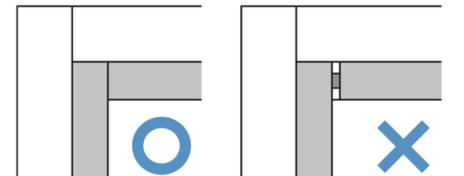
❗ パッキンは「ヒレ」が枠に当たる向きに差し込んでください(下図参照)。逆向きに差し込むと音漏れや動作不具合の原因になる可能性があります。
