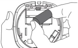
②接続コネクタを引き抜き、電池を取り出す。交換の場合は新しい電池のコネクタを接続し、電池を入れ電池カバーを閉める。
