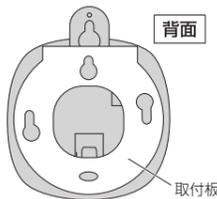
警報器の背面を上にして外枠を持ち、もう片方の手の平で押しながら左に回します。1cmほど回れば外れます。
