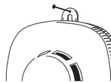
**注意** 取付ネジは締めすぎないように注意してください。引掛フックが破損する場合があります。石こうぎを下方向から打ち込むとくぎが抜けやすく、警報器が外れる場合があります。
