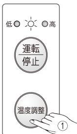
①[温度調整]ボタンを押してお好みの温度に調整します。
