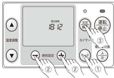
●電源を初めて供給した時や停電した後には、1:00で点滅しています。
