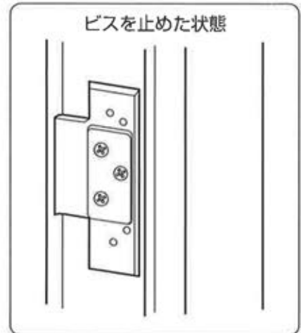
枠側の切欠き図
