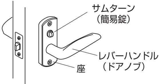
錠セット交換の際、レバーハンドル(ドアノブ)を取り外す必要が有りますが、サムターンが付いている場合と付いて無い場合、および錠のタイプにより作業行程が異なります。下図を参考に作業して下さい。
