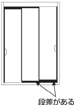
戸車の上下調整ネジを、下図の要領で調整して下さい。
