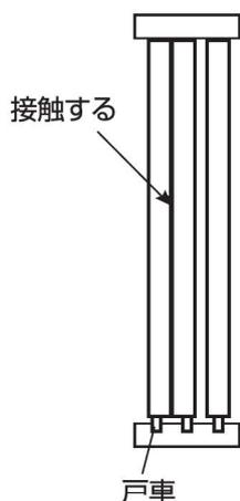
戸車の左右調整ネジを、下図の要領で調整して下さい。
