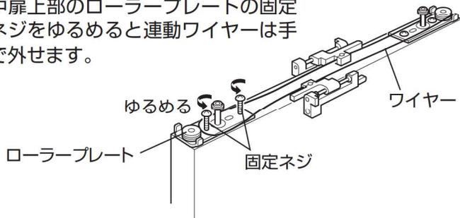
ローラープレートに新しいワイヤーを引っ掛け、ローラープレートの固定ネジを再び締め付けます。
