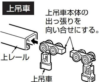
◆ 扉1セットにつき、上吊車2個を本体の**長い方**を向い合せにして、上レールに差し込んで下さい。
