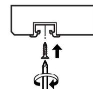
❗ 上レールの取付時は吊車を落下させない様に上レールを持っている手の方に寄せて行って下さい。
