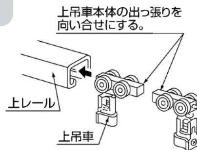
扉1セットにつき、取り替える上吊車と替えない上吊車2ヶを本体の長い方を向い合せにして、上レールに差し込んで下さい。
