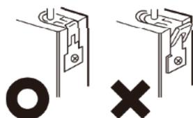
⚠ 扉の取り付けが不十分な場合、扉が倒れるおそれがありますので、必ず上吊車、ガイドローラーが確実に扉側面に入っている事を確認して下さい。
