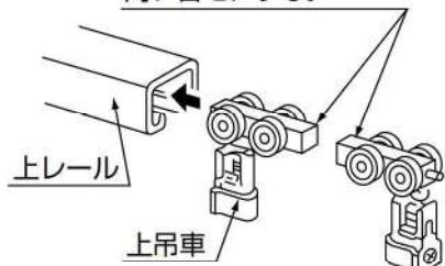
扉1セットにつき、取り替える上吊車と替えない上吊車2ヶを本体の長い方を向い合せにして、上レールに差し込んで下さい。
