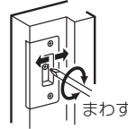
調整ラッチ受座の操作方法 (調整可能範囲5mm)
