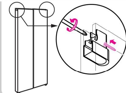
取り付けネジを外し、吊車用ベースを外して下さい。
