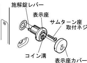
※表示座を取り付ける時はコイン溝を縦にし、表示の青色が上になっていることを確認してから、サムターン座のサムターンを縦にして組み合わせてください。(取付方法6参照)
