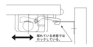
キャビネットが揺れている状態では、内部のボールの 動きにより本体のロック部品が下がった状態を維持し ているのでロック状態が解除されません。
