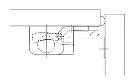
揺れが止まり、内部のボールが止まると、ロック部 品は自然と上がるので、扉を閉めた状態にしておけ ばロックが解除されます。
