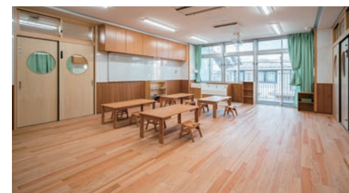
床材：コミュニケーションタフ DW（地域産材対応突板） 〈多摩産材杉〉 耐震天井工法：ダイケンハイブリッド天井
