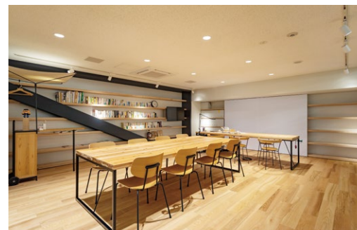
床材:コミュニケーションタフ FW 天井材:ダイロートン ギンガ4 (現場塗装)
