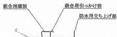
B図 接合部材形状図
