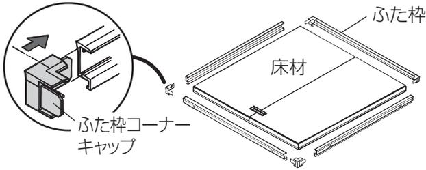
※ふた枠と床材がすれて音鳴りがする場合、床材・化粧板を軽く面取りして固定し直して下さい。
