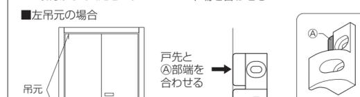
※リード穴を開けてから取付けしてください。扉下端から20mmの位置に合わせる
