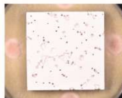
防カビ加工品 試験後写真 〈評価値：0〉
