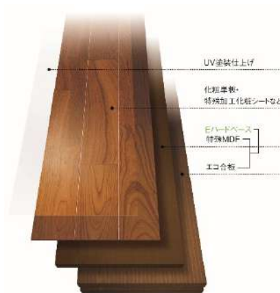
製品構成図 (「Eハードベース」を使用した床構成イメージ)
