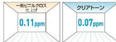
※1 ホルムアルデヒド吸着試験/[環境条件仕様]室温30℃、相対湿度50%、換気回数0.5回/時(自社測定値) 部屋の大きさ:6畳、クリアトーン12S天井材内装率:19%
