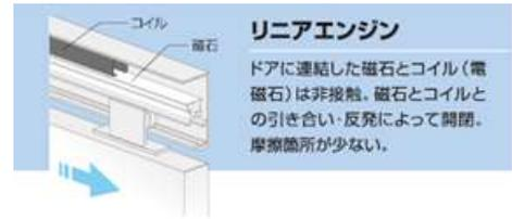
※停電などで電源の供給が途絶えた場合には、通常の吊戸として開閉できます。
