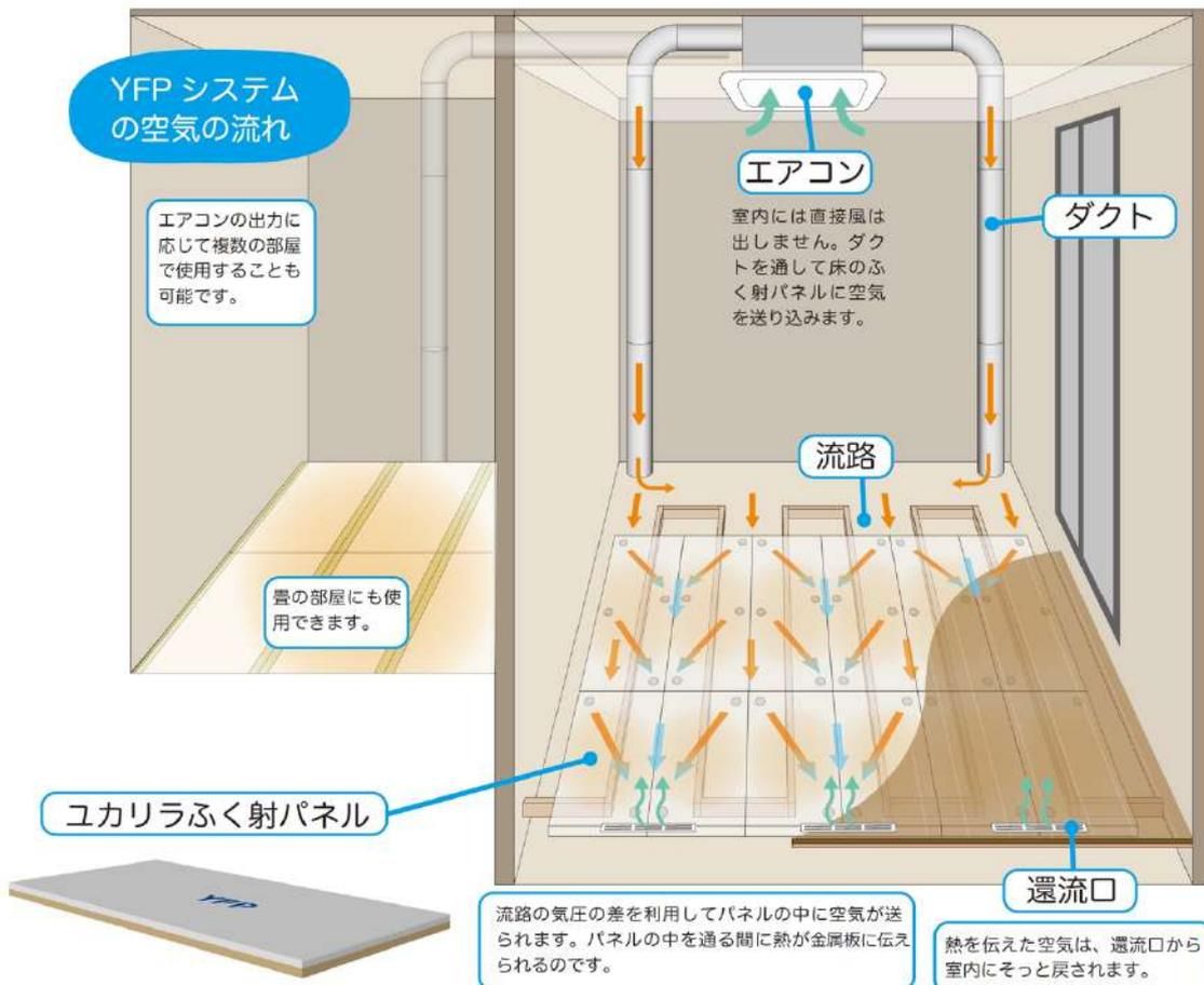
エアコンの風が、ダクトを通してフローリングの下の「ユカリラふく射パネル」に送られます。風がパネルの中を通る間に、熱がパネル表面の金属板に伝えられ、床仕上げ材の表面からふく射熱として室内に届きます。
