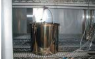
建材のVOCを測定する「小型チャンバー」
