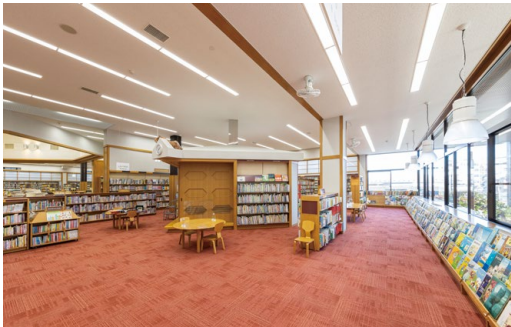
耐震天井工法: ダイケンハイブリッド天井 天井材: ダイロートトラバーチン9mm
