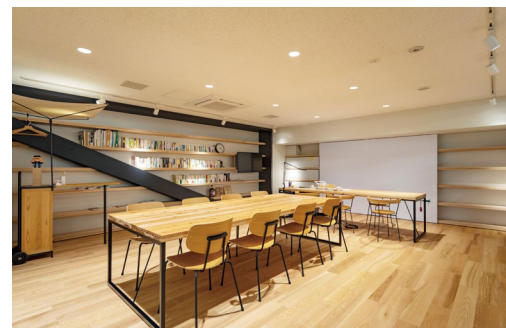
床材:コミュニケーションタフ FW 天井材:ロックウール化粧吸音板 ダイロートン ギンガ4(現場塗装)
