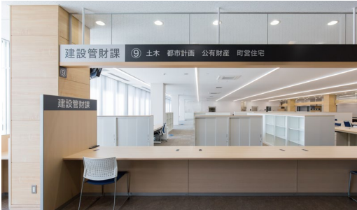
不燃壁材:グラビオUB<UB71> 天井材:ロックウール化粧吸音板 ダイロートン トラバーチン9mm
