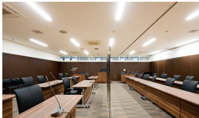
不燃壁材：グラビオフィットUB〈UB32〉 天井材：ダイロートン トラパーチン 12mm
