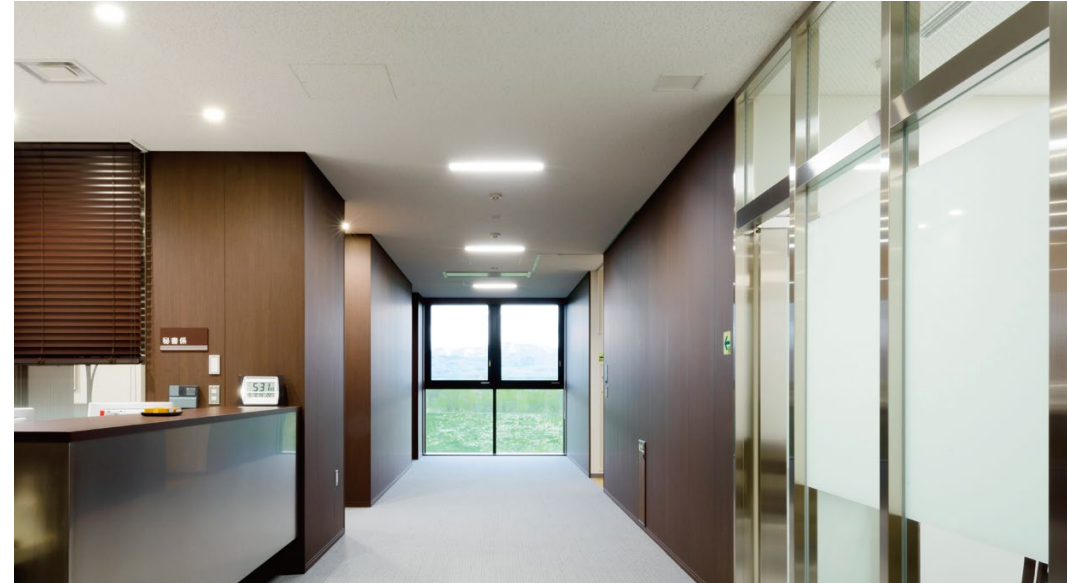
不燃壁材：グラビオフィットUB〈UB32〉 天井材：ダイロートン トラパーチン 12mm
