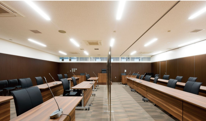
不燃壁材：グラビオフィットUB〈UB22〉・〈UB32〉 天井材：ロックウール化粧吸音板 ダイロートン トラバーチン12mm
