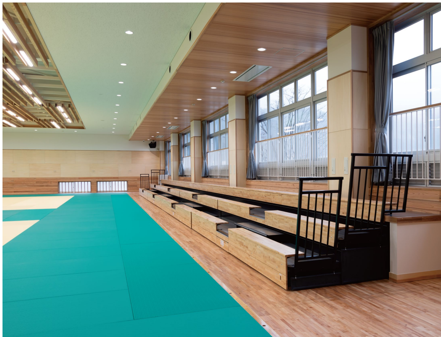
天井材：富山県産材スギ突板張り ダイライト不燃パネル
