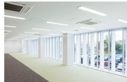
天井材: ロックウール化粧吸音板 ダイロートン トラバーチン
