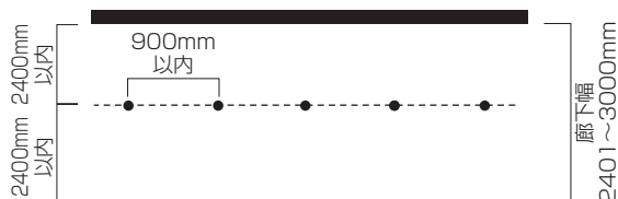
壁面から2400mm以内の箇所で一列 打設されている場合
