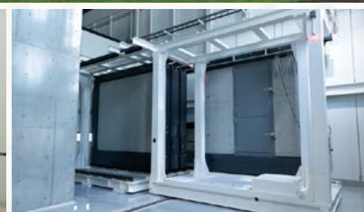
音響材料移動装置
