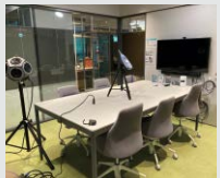
会議室の音環境測定を通して、音響調整部材を挿入
