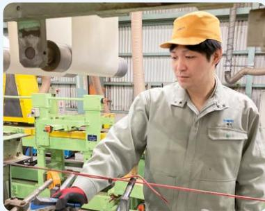
井波工場ではドアや造作材などの内装建材を製造しており、私は窓枠や巾木といった建築用造作材生産のラッピング工程で班長を務めています。ラッピング工程とは、化粧シートに接着剤を塗布し、成型機を使って基材に貼り付ける工程です。この工程は、気温などの外的要因により品質が変動しやすいため、基材の温度管理や接着剤の塗布量の調整が非常に重要であり、ヒーター設備の制御などを通じて、常に安定した品質の製品を提供できるよう努めています。
