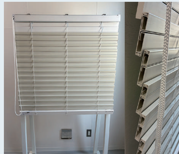
ブラインド吸音体のプロトタイプ(右) 側面
