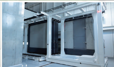
音響材料移動装置
