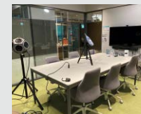
会議室の音環境測定を通して、音響調整部材を導入
