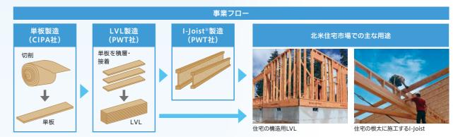
※I-Joist(I-型ジョイスト):OSB(Oriented Strand Board:原木から切削された長方形の薄い木片を表面層とコア層で繊維方向に直交するように重ねて高温圧縮した構造用木質ボード)と LVLや製材の複合による構造材。
