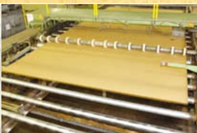
●岡山大建工業(株)のインシュレーションボード製造ライン
